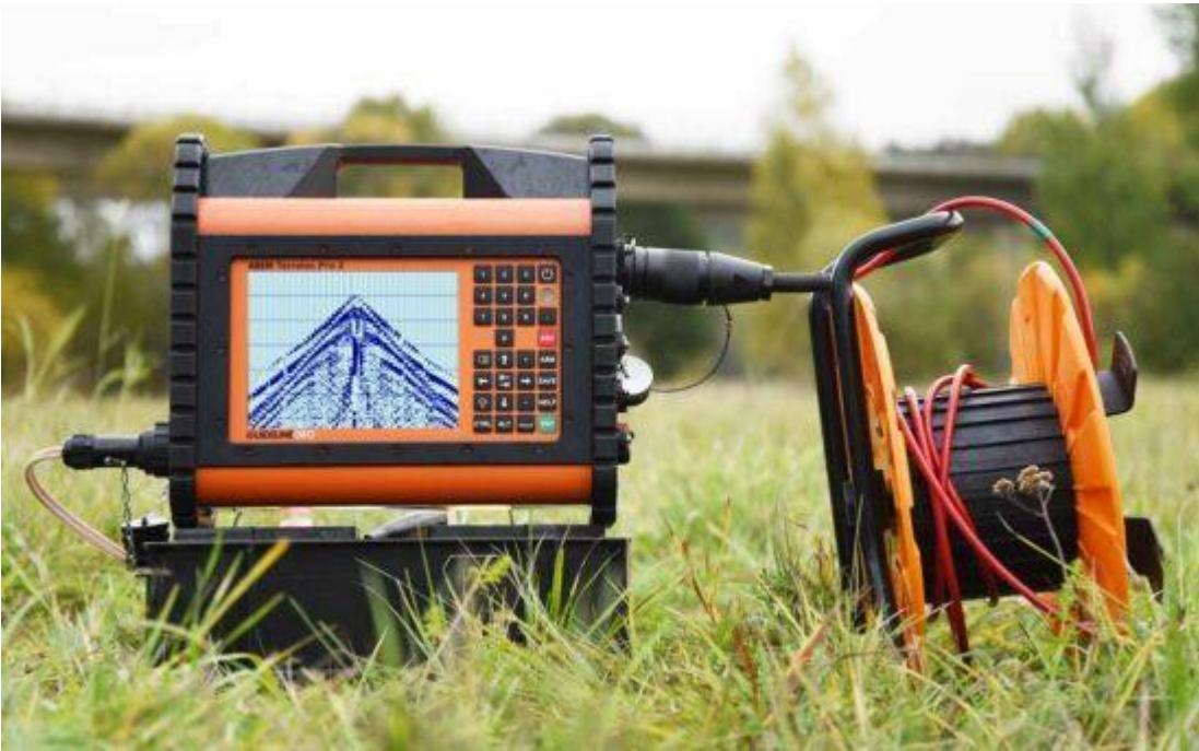
Figure 23 Seismograph ABEM Terraloc (GPR, n.d.).
