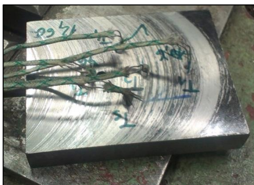
Obr. 30 Zapojení termočlánků na vzorek.
