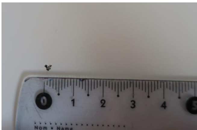
Obr. 32) Příklad vady materiálu způsobené nečistotami
