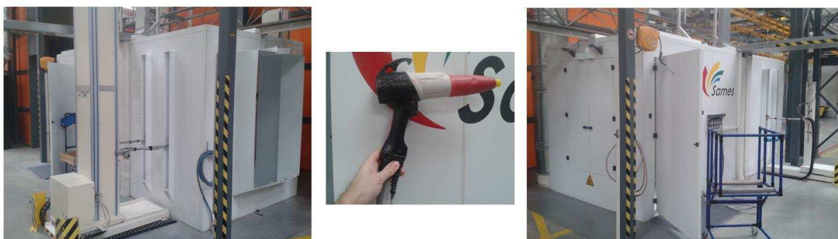
Obr. 23) Zleva: lakovací kabina 2, aplikační pistole, lakovací kabina 1
