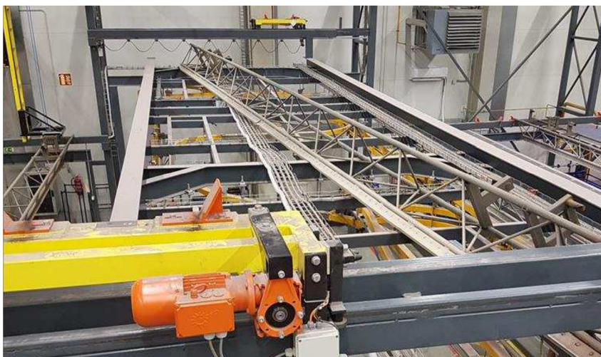
Obr. 28) Pád šíny v důsledku chyby SW
