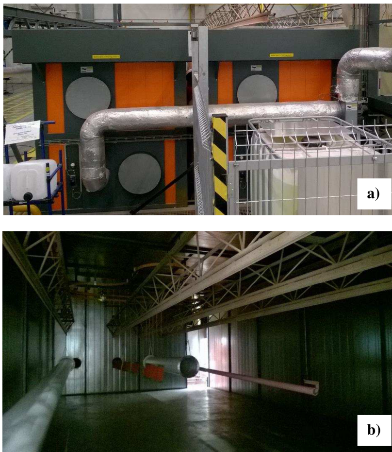
Obr. 21) a) plynové sušící pece, b) chladicí box
