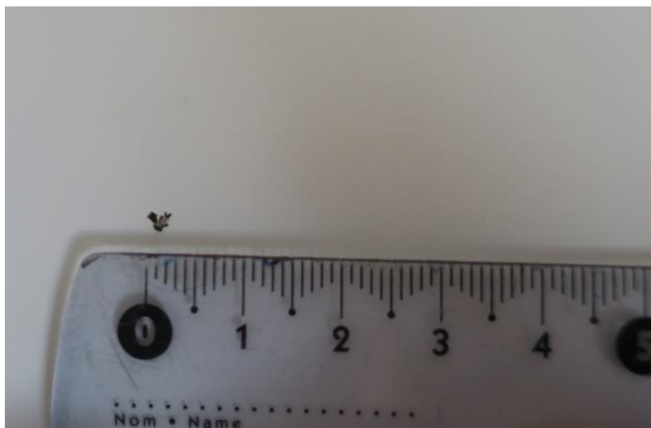
Obr. 32) Příklad vady materiálu způsobené nečistotami
