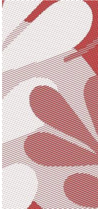
Obrázek 62. Detail třídy haluzek ve vazbách desetivazného atlasu
