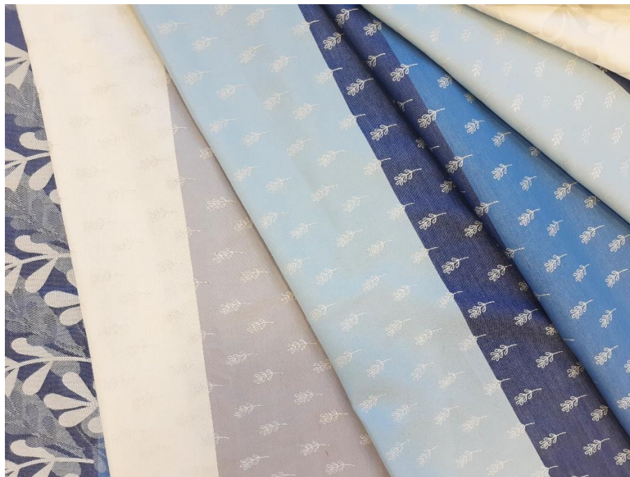
Obrázek 71. Utkané vzorky tkaniny v odlišných odstínech, vazbách a dezénech
