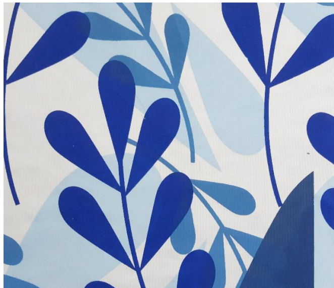
Obrázek 81. Zkouška tisku modrých odstínů na zátažnou obouliční pleteninu
