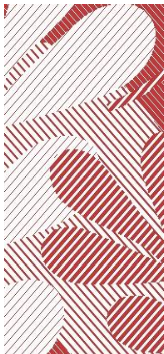
Obrázek 64. Detail třídy ve vazbách desetivazného kepru
