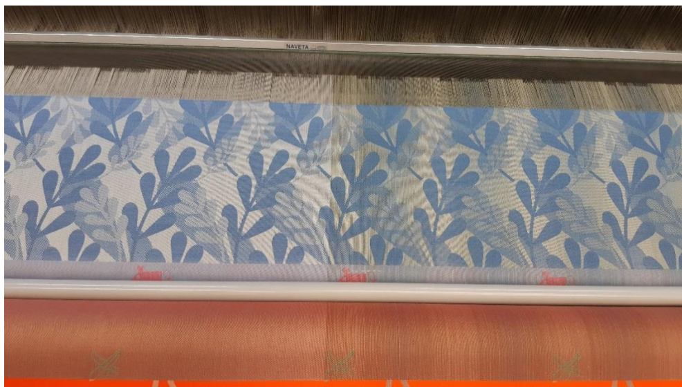
Obrázek 70. Realizace zkušebních vzorků tkaniny s půlenou barevností osnovy
