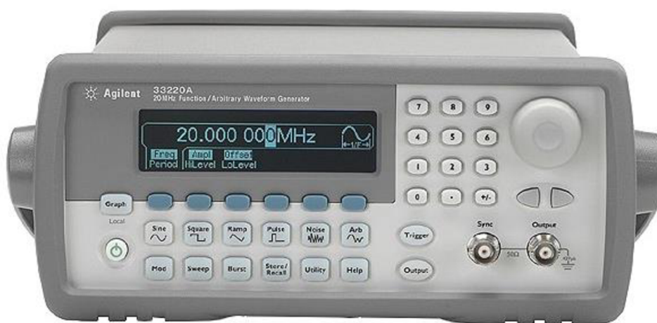
Obr. č. 6: Funkční generátor Agilent 33220A
