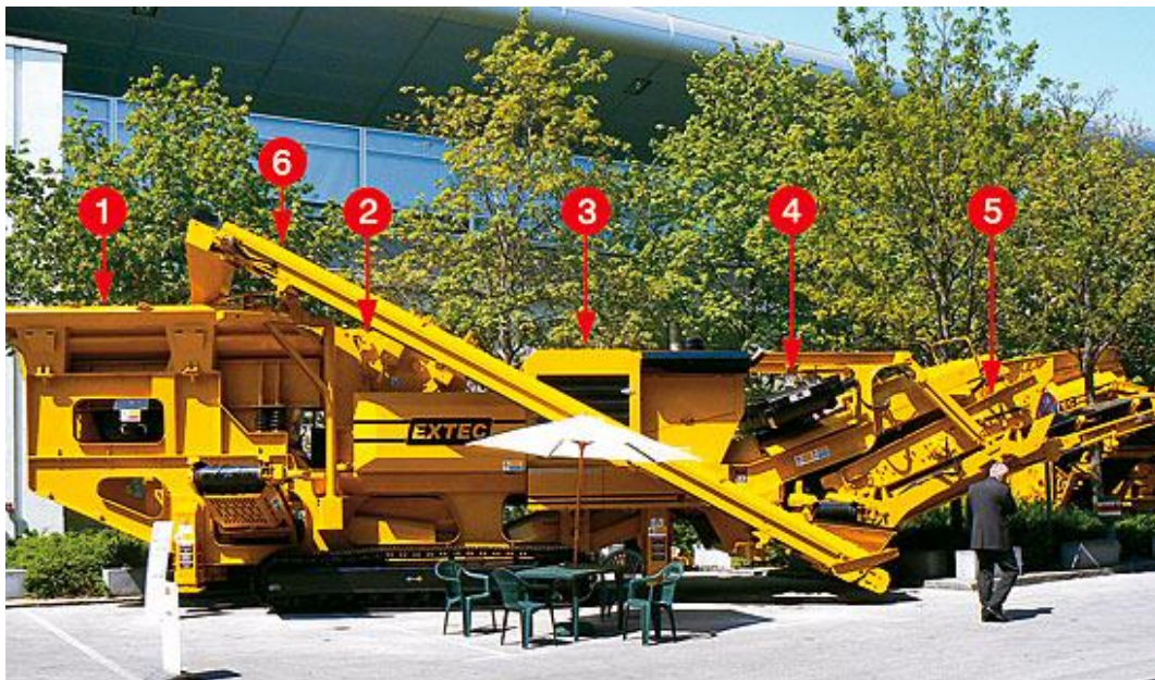
Obr. 2 Kombinovaná recyklační linka se zpětným vedením nadsítné složky 1) násypka s předtřídičem 2) odrazový drtič 3) hnací agregát (spalovací motor) 4) magnetický separátor 5) vibrační třídič 6) zpětný pás[8]
