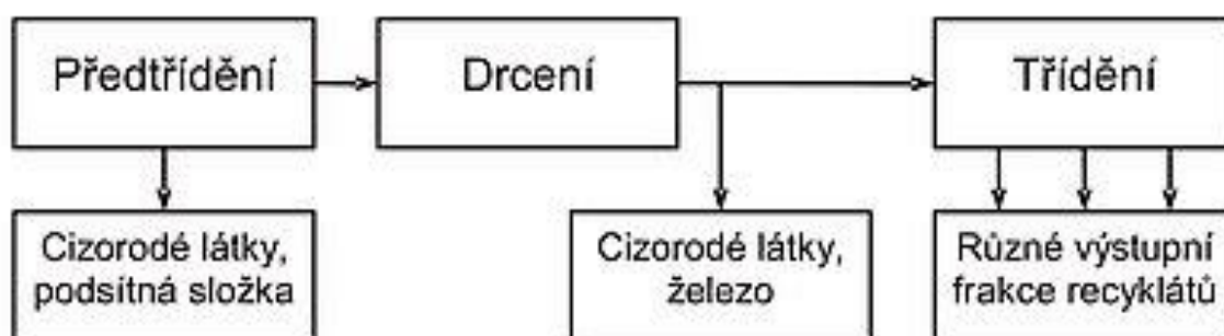
Obr. 1 Schéma typického recyklačního zařízení[8]
