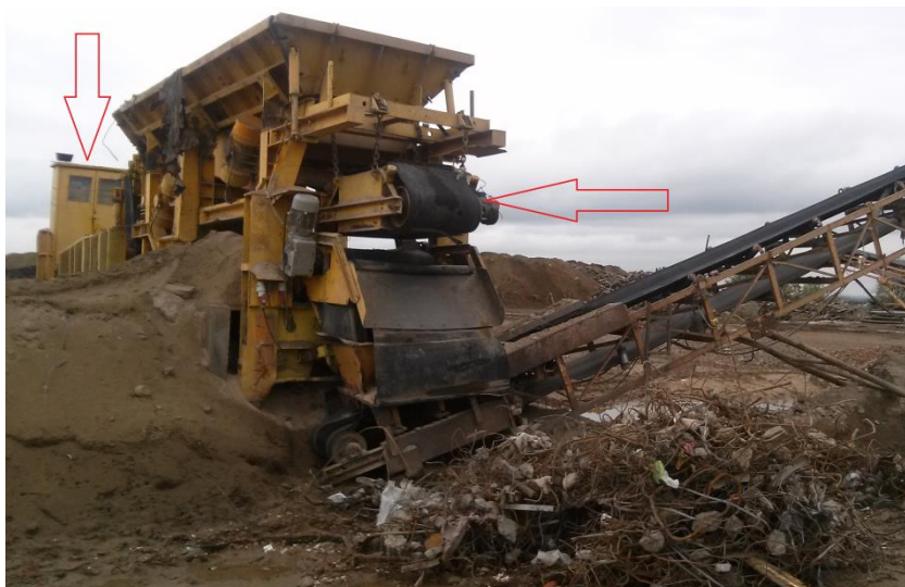
Obr. 9 V popředí mag. odlučovač, v pozadí el. rozvaděč a ovladač
