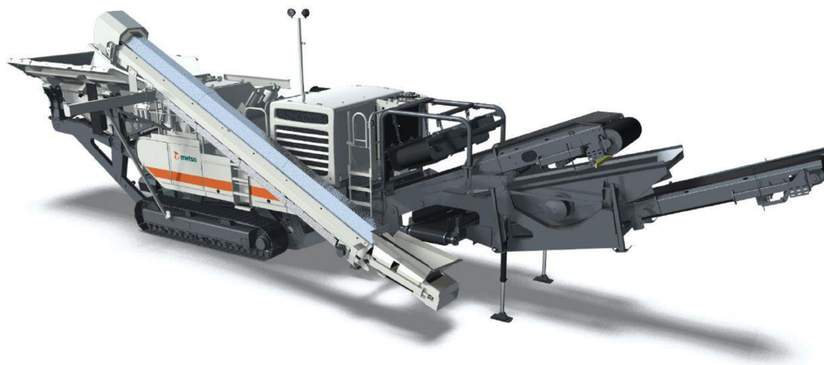
Obr. 15 Mobilní drtiči a třidicí linka Metso LT1110S[19]
