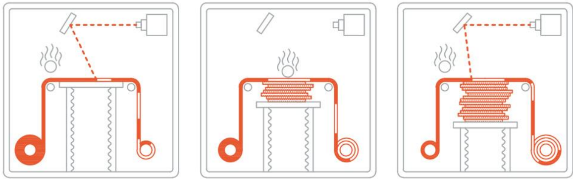
Obrázek 7 Princip metody Sheet Lamination
