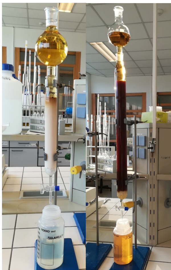
Obr. 17: Adsorpce FK na pryskyřici DAX-8 (vlevo); zpětná protonace roztoku FK pomocí pryskyřice Amberlite (vpravo)
