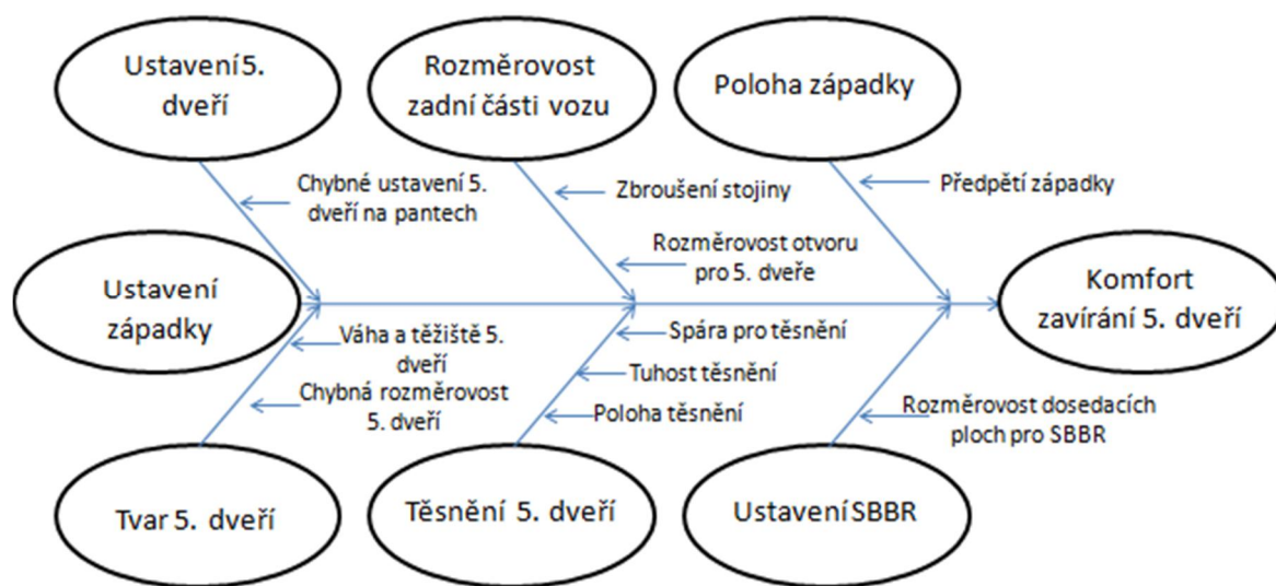
Obr. 10 Ishikawův diagram vlivů na komfort zavírání pátých dveří
