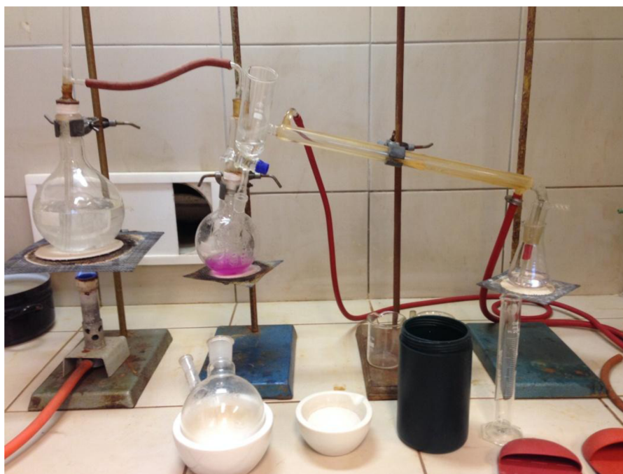
Obr. 4: Aparatura na stanovení dle Kjeldahla
