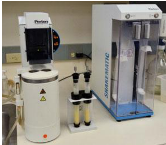
Obr. 6: Přístroj na stanovení čísla poklesu s třepačkou [52]
