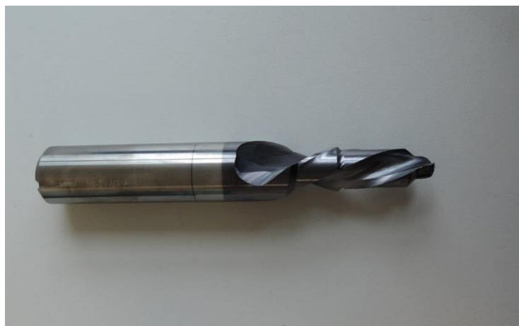
Obr. 4.3 Vyrobený sdrúžený nástroj.
