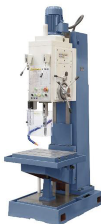
Obr. 1.16 Stojanová vrtačka německé firmy Bernardo [16].
