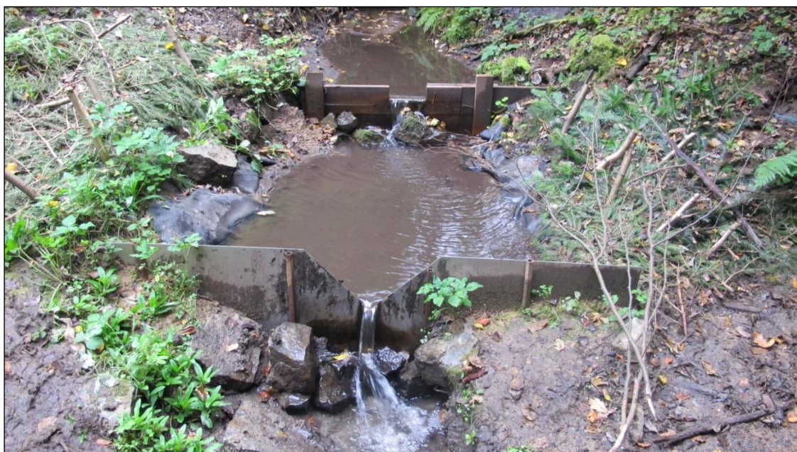
Obr. 3/I. Kanice – měřicí aparatura v závěrném profilu
