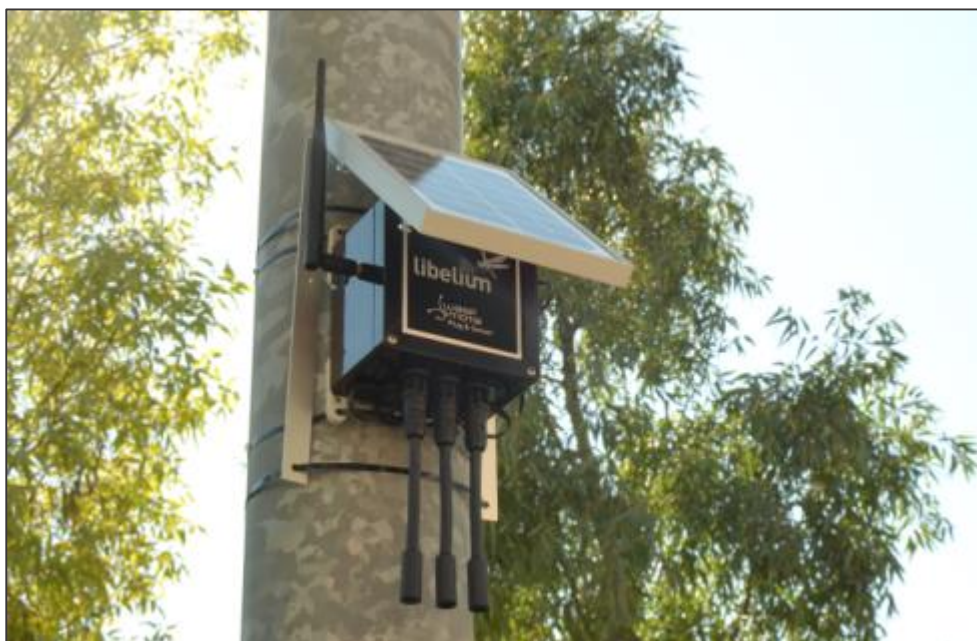
Obrázok č. 21: uzol dobíjaný solárnym panelom
