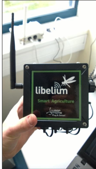
Obrázok č. 17 a 18: uzol Smart Environment (vľavo) a Smart Agriculture (vpravo) Zdroj: autor
