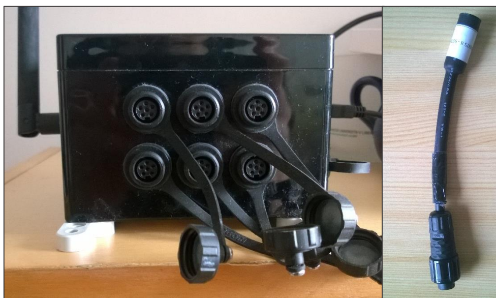
Obrázok č. 16: sloty na uzly Smart Environment (vľavo) a ukážka senzoru (vpravo) Zdroj: autor
