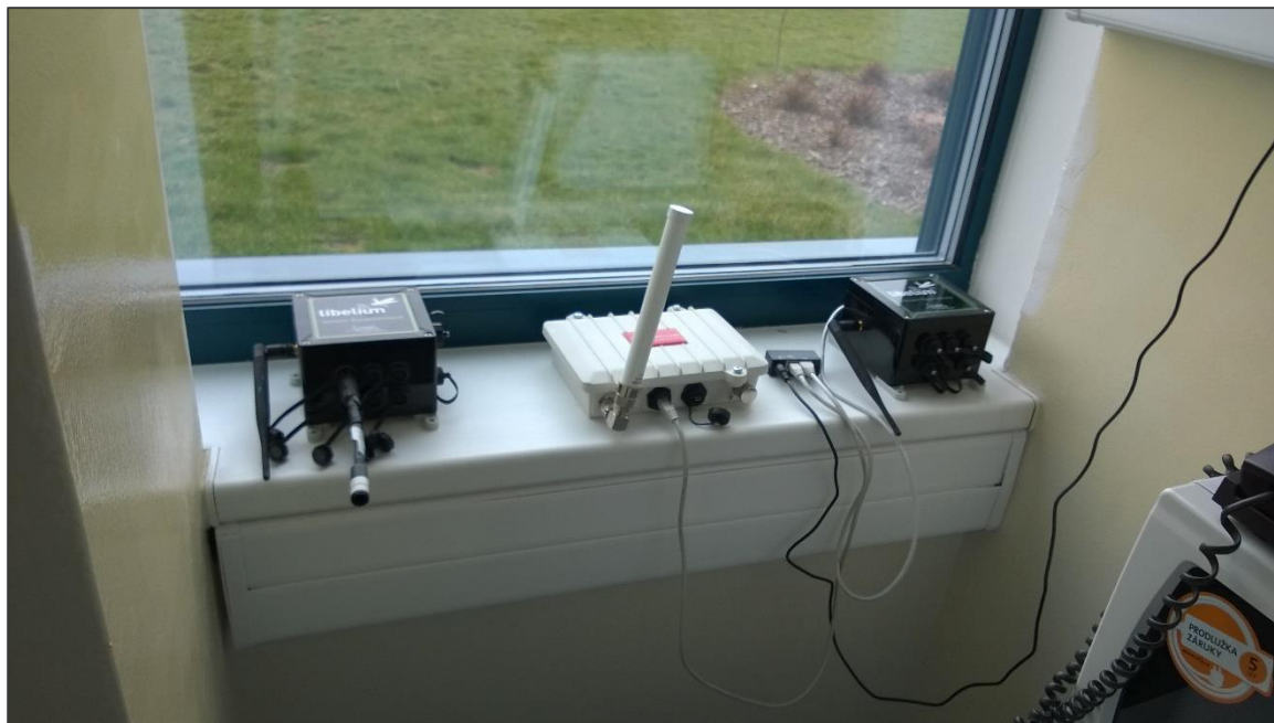
Obrázok A: brána Meshlium a uzle Smart Agriculture Zdroj: autor
