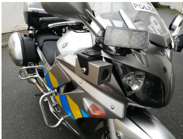
Obrázek 8: Kamera PolCam na motocyklu Yamaha FJR 1300
