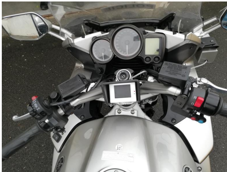
Obrázek 9: Ovládání systému PolCam na řídítkách
