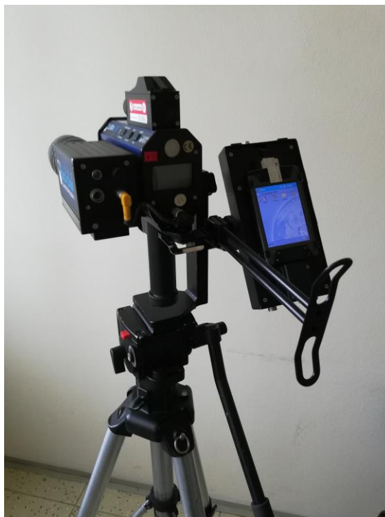
Obrázek 5: Laserový rychloměr Micro DigiCam LTI (UltraLyte 100 LR)
