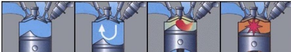
Obrázek 14: Princip zapálení vrstvené směsi [34]
