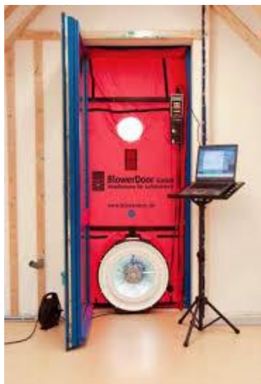
Obr. 45: Příklad přístroje Blower - Door (zdroj: [36])
