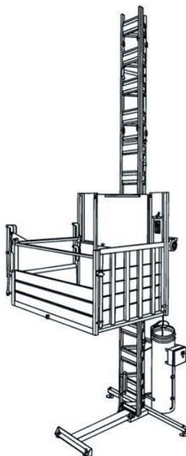
Obr. 32: Staveništní výtah (zdroj: [18])
