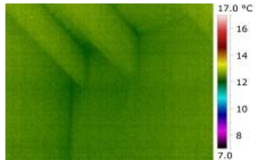
Obr. 69: Termogram správně provedené parozábrany (zdroj: [42])
