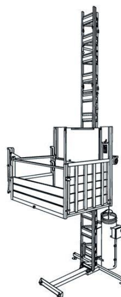
Obr. 25: Staveništní výtah (zdroj: [18])
