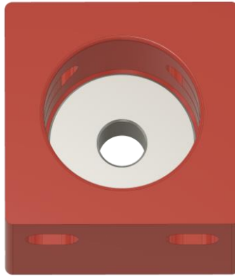
Obr. 92 Nalisování ložiska do domku
