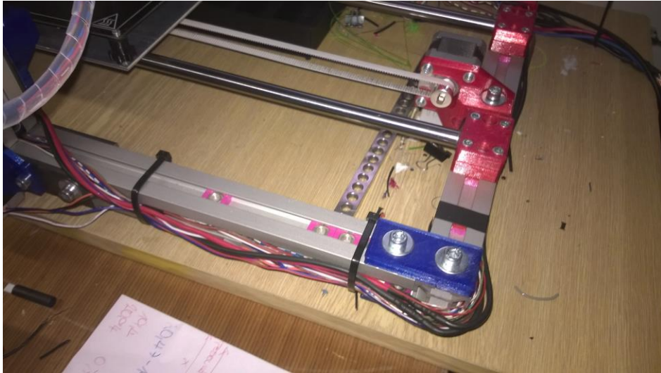
Obr. 169 Vedení svazku od extruderu 2 a vyhřívané podložky do krabičky
