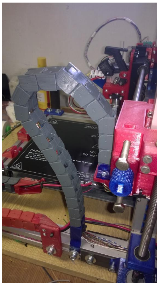
Obr. 167 Svazek extruderu 2 protažen řetězem
