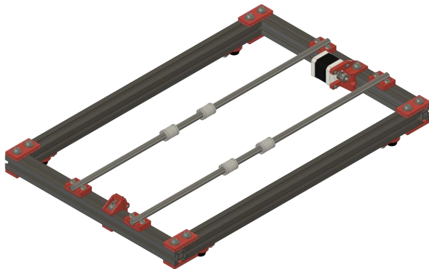
Obr. 21 Umístění vodících tyčí Y na rám Y
