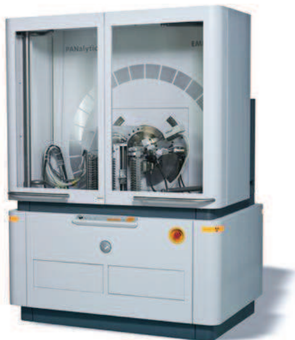
Obrázek č. 13: Difraktometr Empyrean od firmy PANalytical [28]
