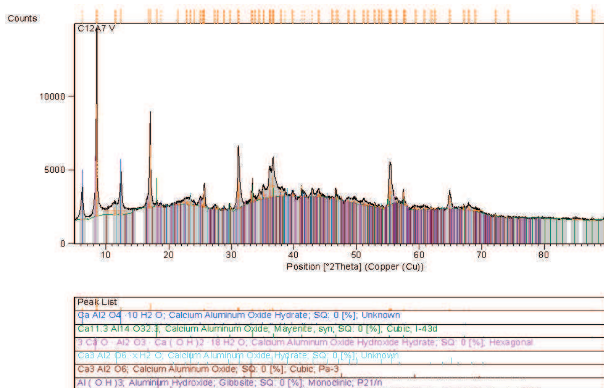
Obrázek č. 25: XRD difraktogram strukturální analýzy hydratované fáze C_{12}A_7 při teplotě 20 °C a tabulka s jejími hydratačními produkty
