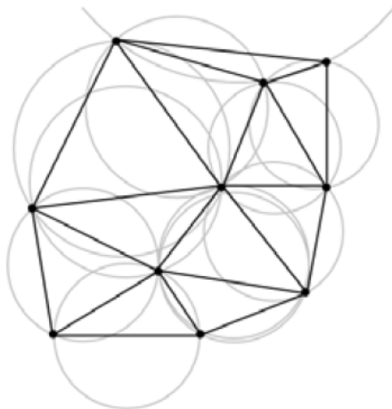
Obr. 3.3 Datové struktury pro ukládání TIN[5]
