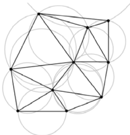
Obr. 3.3 Datové struktury pro ukládání TIN[5]
