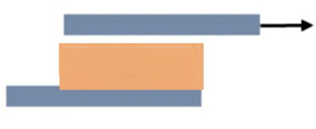
Obrázek 16. Adhezivní porušení spoje, [53]
