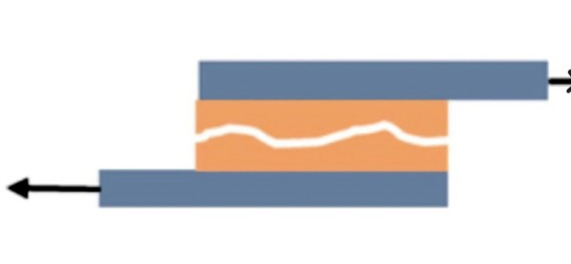
Obrázek 17. Kohezní porušení spoje, [53]
