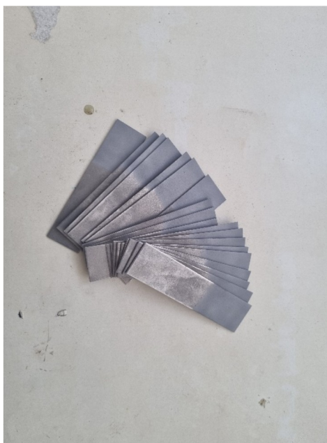
Obrázek 10. Vzorky po zdrsnění povrchu, [zdroj autor]
