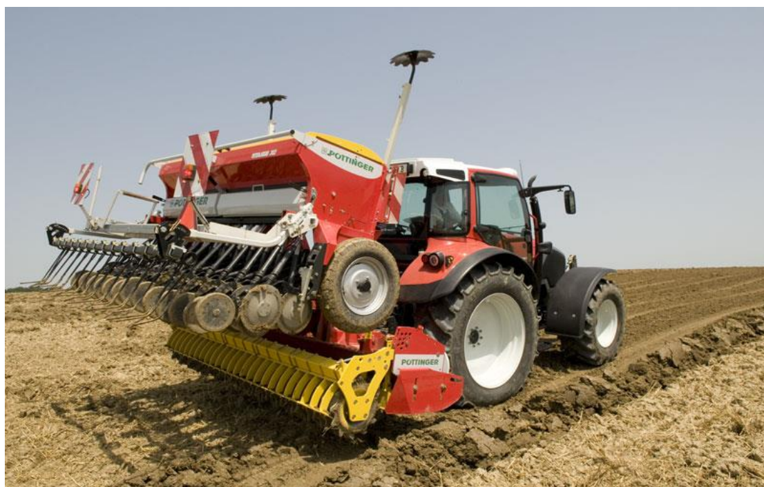
Obr. 04) Secí stroj Pöttinger Vitasem 302 A v agregaci s rotačními bránami Pöttinger Lion 303. (Zdroj: https://www.poettinger.at/cs_cz )
