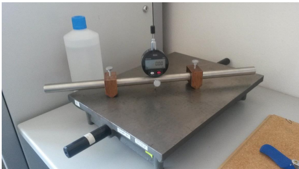
Obr. 39 - Kalibrace přípravku s úchylkoměrem
