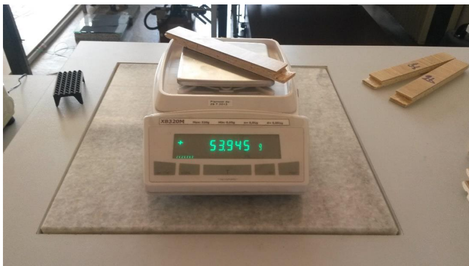
Obr. 33 - Vážení vlhkostních vzorků
