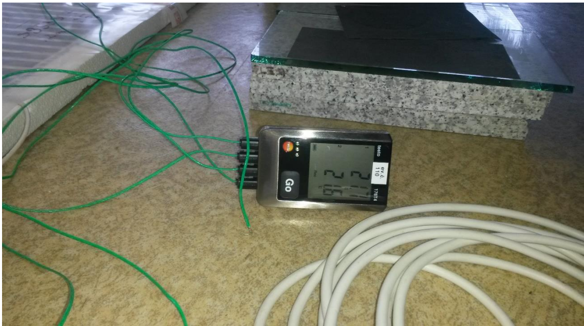
Obr. 44 - Dataloger zaznamenávající teploty na jednotlivých čidlech
