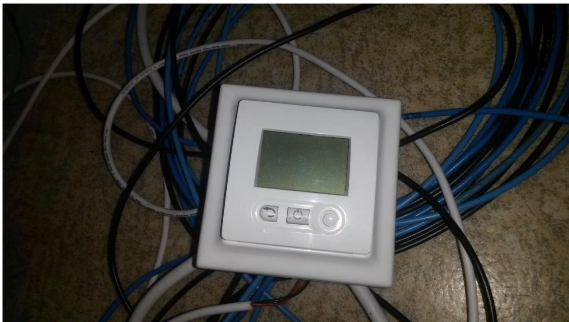
Obr. 45 - Termostat ragulující teplotu topných fólií
