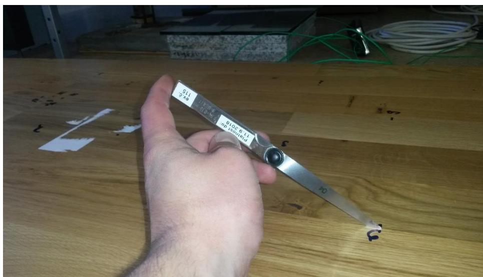
Obr. 41 - Měření spár mezi dílci pomocí ocelových měrek
