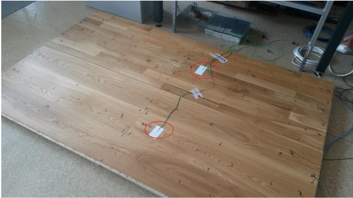
Obr. 43 - Umístění čidel pro zaznamenávání teploty na povrchu
