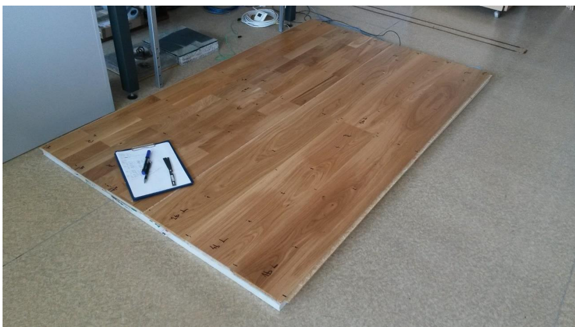
Obr. 37 - Vzorky podlahovin umístěných na topné ploše fólie
