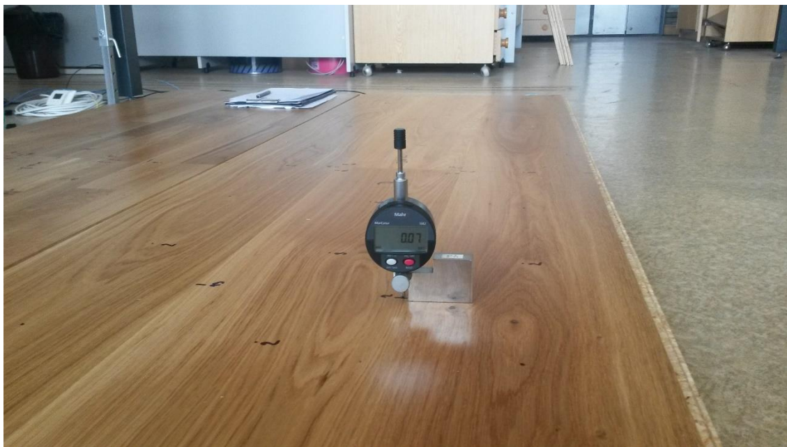
Obr. 42 - Měření výškového rozdílu sousedících dílců
