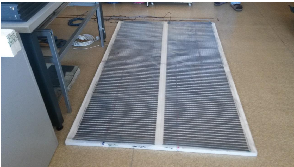
Obr. 36 - Zakrytí topných fólií celistvou vrstvou fólie, jako izolace proti vodě
