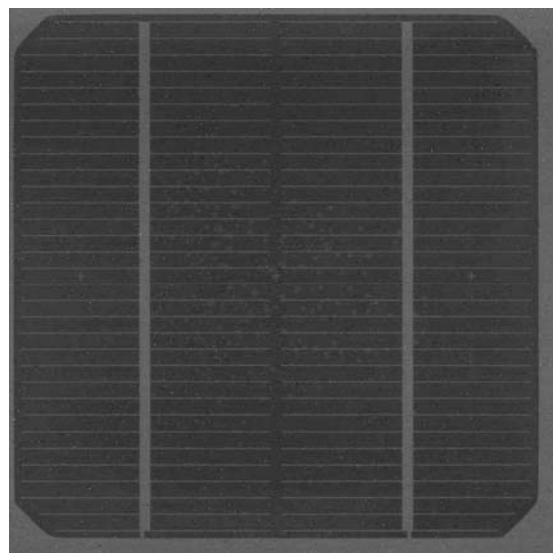
b) LBIC-vz. C, UV dioda
