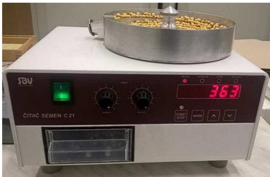
Obrázek 10: Čítač semen (C 21), přístroj na měření hmotnosti tisíce semen (HTS) v laboratoři Fakulty agrobiologie, potravinových a přírodních zdrojů ČZU v Praze, (autor: Jan Rejman)
