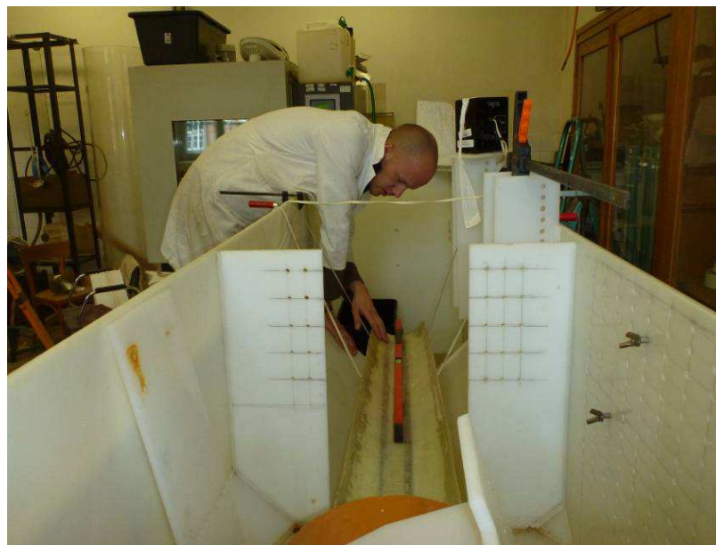
Obr. 4.15 Nastavenie sklonu otvoreného žlabu
