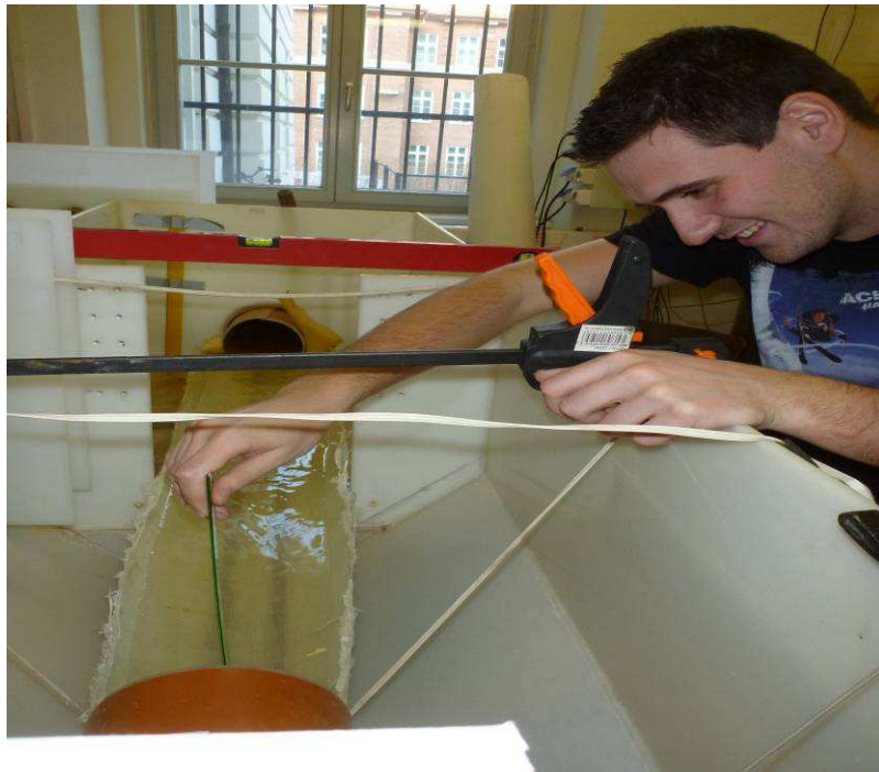
Obr. 4.14 Meranie výšky hladiny v priebehu prietoku vody
