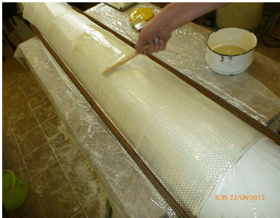
Obr. 4.3 Nanášanie laminátu na formu
