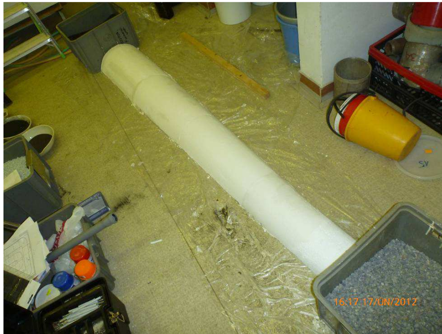
Obr. 4.2 Pripravená forma na laminátovanie
