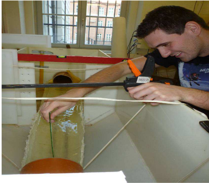
Obr. 4.14 Meranie výšky hladiny v priebehu prietoku vody
