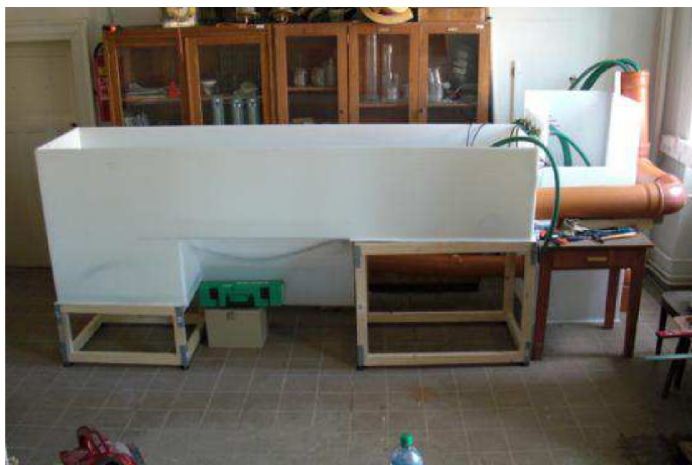
Obr. 4.8 Použitie modelu lapáku piesku pre umiestnenie otvoreného laminátového žľabu
