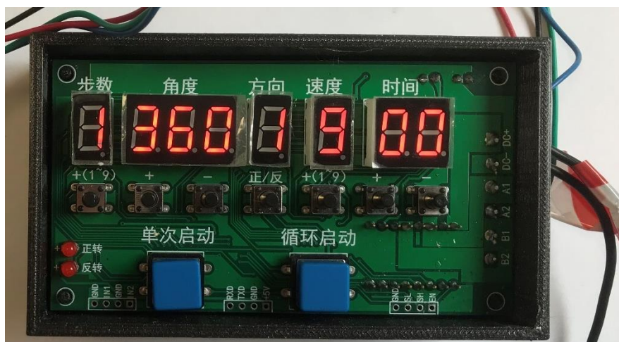
Obr. č. 38 Manuálně programovatelné ovládání uložené do krabičky. Foto autor.
