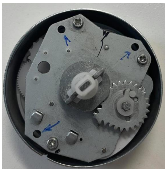
Obr. č. 34 Detail mechanismu pro pohon. Foto autor.
