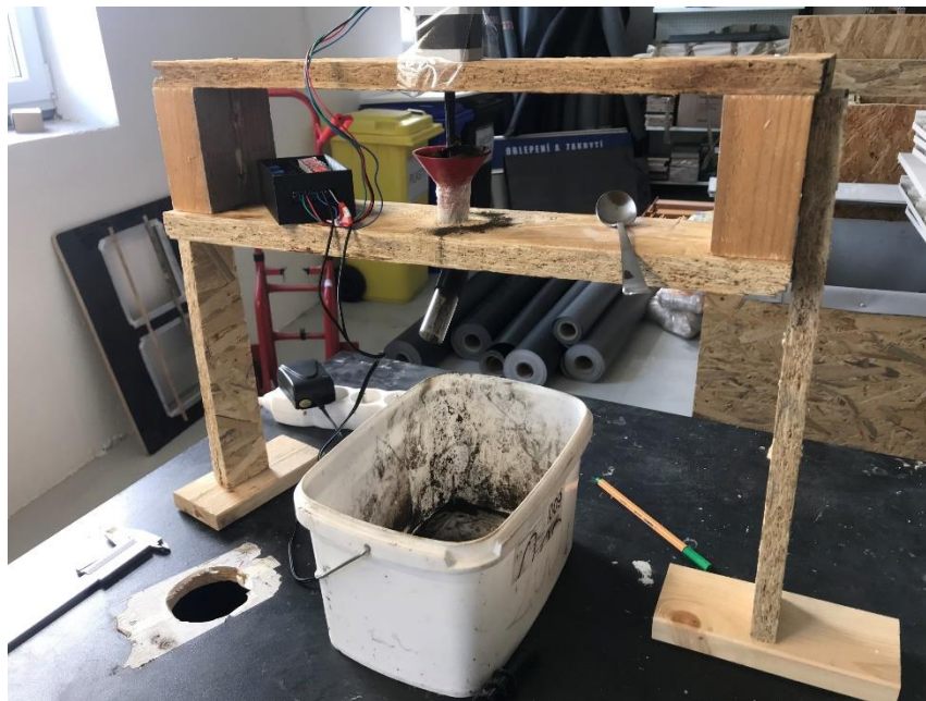
Obr. č. 44 Sestava pro testování šnekového dopravníku. Foto autor.
