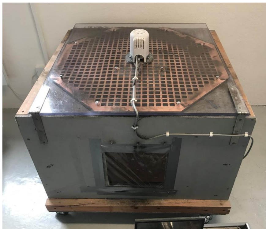
Obr. č. 51 Zkušební komora před namontováním dávkovače č. 2 a Peltiérových článků: Foto autor.
