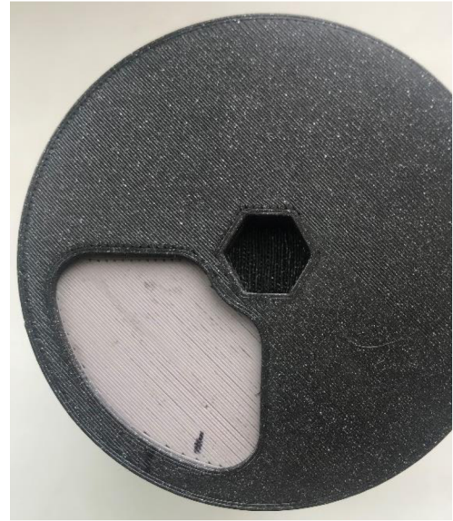
Obr. č. 36 Zásobník na popílek s nasazeným víčkem v startovní pozici. Foto autor.
