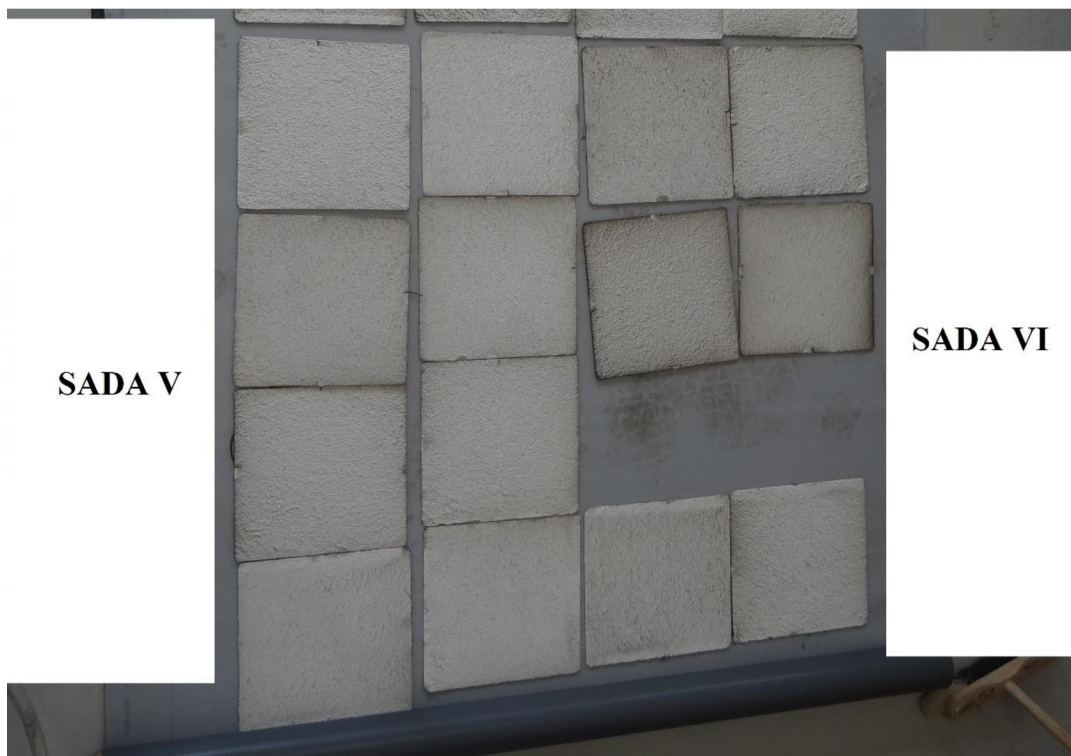
Obr. č. 60 Sada V a VI po simulování znečištění. Foto autor.
