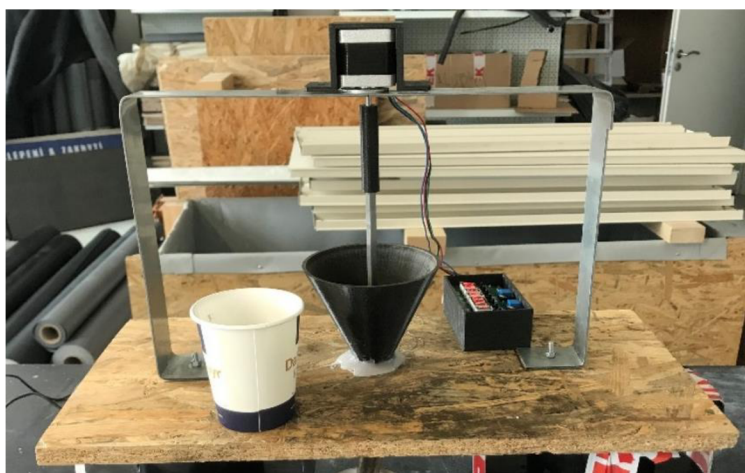
Obr. č. 49 Nová sestava pro druhé testování šnekového dopravníku. Foto autor.
