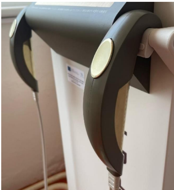
Obrázek 4: Horní elektrody InBody 770 (archiv autorky)
