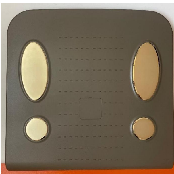
Obrázek 5: Dolní elektrody InBody 770 (archiv autorky)
