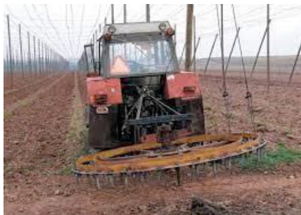
Obrázek 44 - Urovnání povrchu kruhovou branou (Kopecký et al. 2008).
