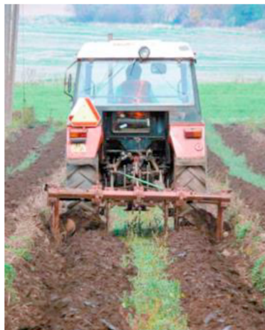
Obrázek 21- Podzimní odorávka dvouradličním pluhem (Chmelařský institut Žatec, s.r.o.).
