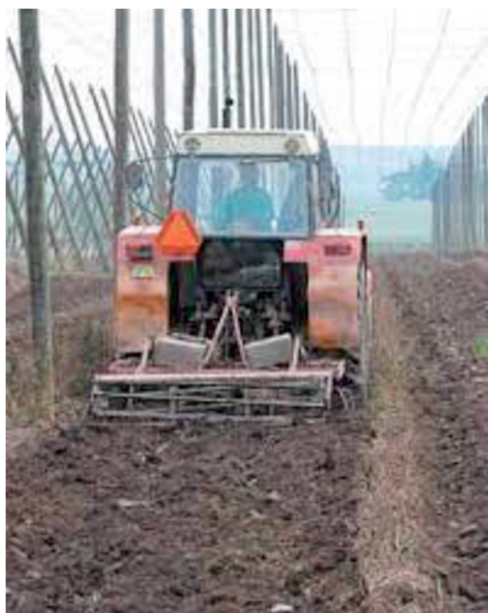
Obrázek 53 - Traktorista urovnávající povrch meziřadí radličkovým půdním kypřičem před řezem (Kopecký et al. 2008).
