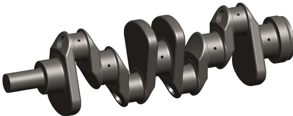
Obr. 10 Varianta s momentovým vyvážením v prostorovém pohledu
