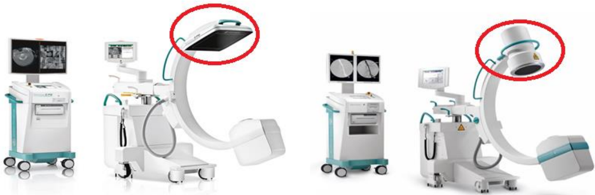
Obrázek 6 Zobrazovací řetězec C-ramene (vlevo s FPD, vpravo se zesilovačem obrazu) (Súkupová, c2011 - 2024)
