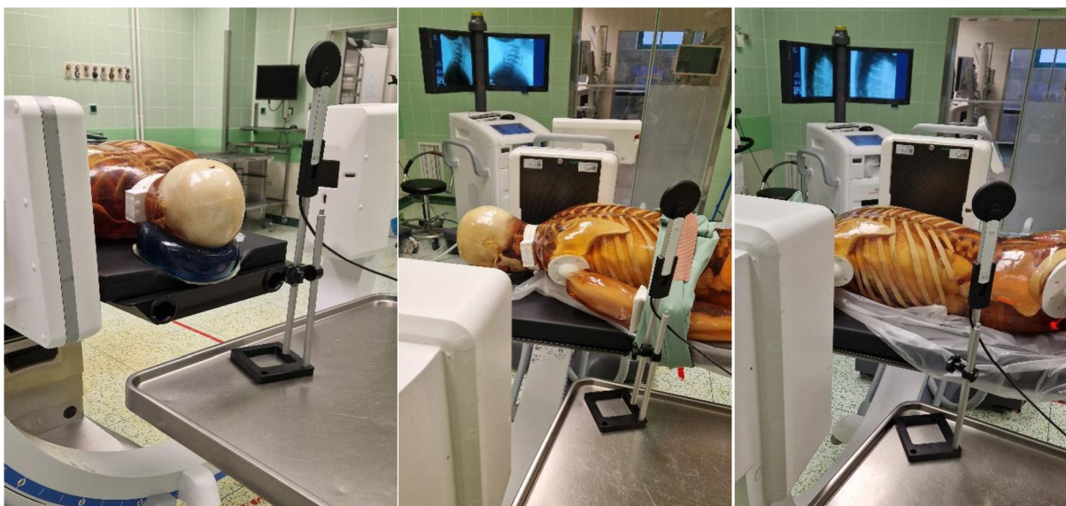
Obrázek 15 Měření rozptýleného záření během skiaskopie
