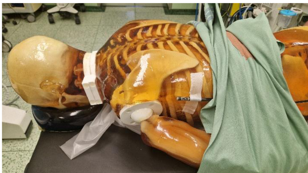
Obrázek 16 Pozice transparentního detektoru pro měření dávky na kůži pacienta během spinální navigace Th-páteře
