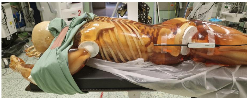
Obrázek 13 Pozice transparentního detektoru pro měření dávky na kůži pacienta během skiaskopického perioperačního zobrazení LS-páteře
