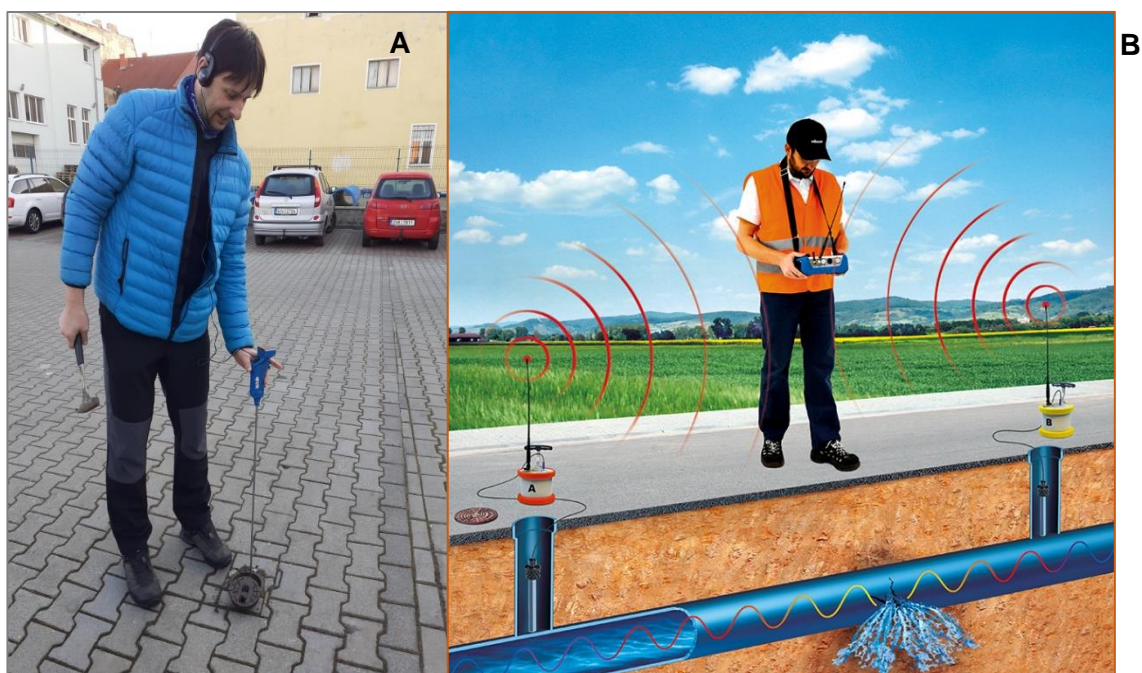
Obrázek č. 2 Testovací tyč v rukou odborníka (obrázek vlevo) zdroj: Vlastní a způsob kolerace vodovodního potrubí (obrázek vpravo) zdroj (SEBA KMT, ©2020)
