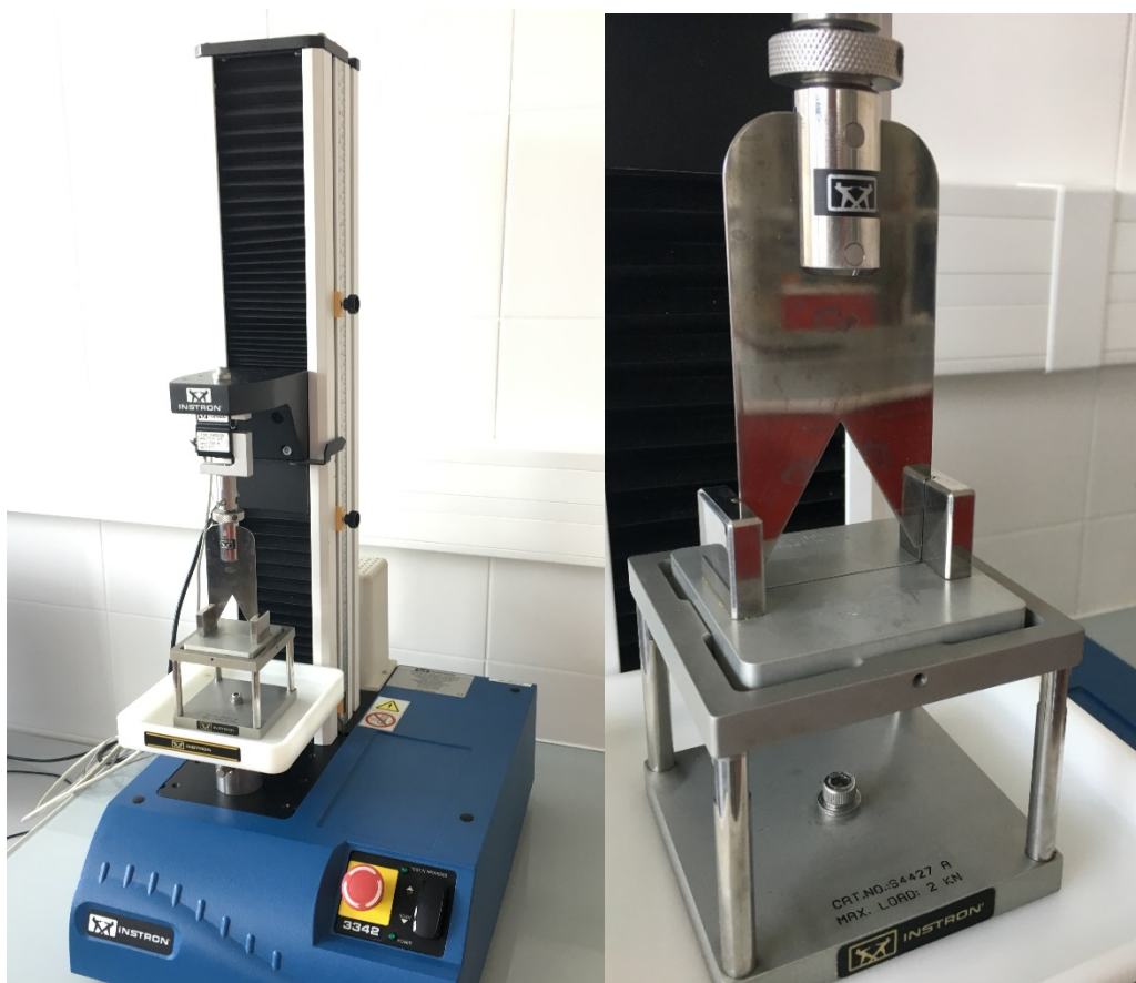
Obrázek 2: Přístroj Instron 3342 s Warner-Bratzlerovým nožem
