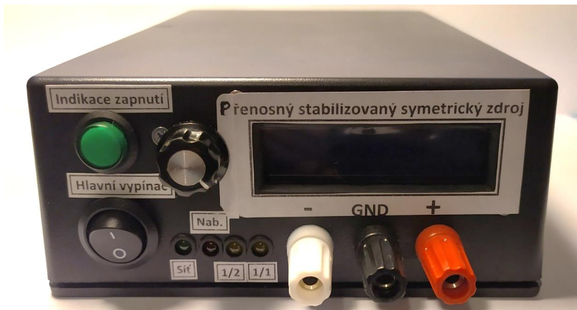
Obr. 2.31: Čelní panel s ovládacími prvky a výstupními svorkami
