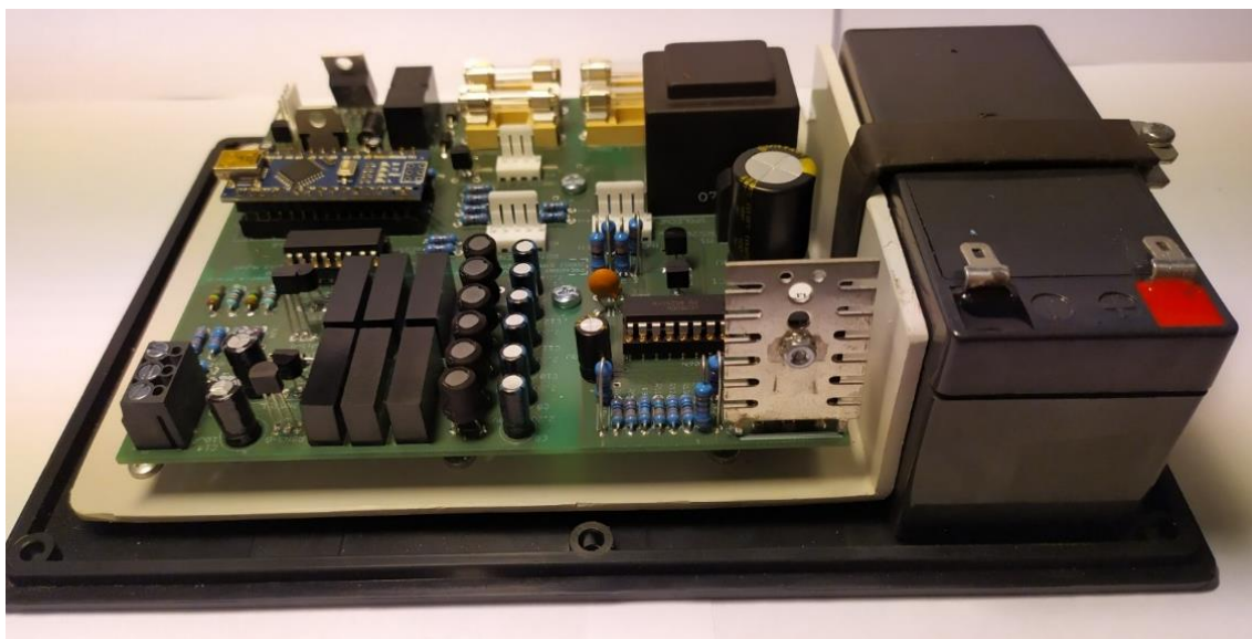
Obr. 2.36: Spodní víko krabičky s připevněnou DPS bez kabeláže a akumulátorem v držáku
