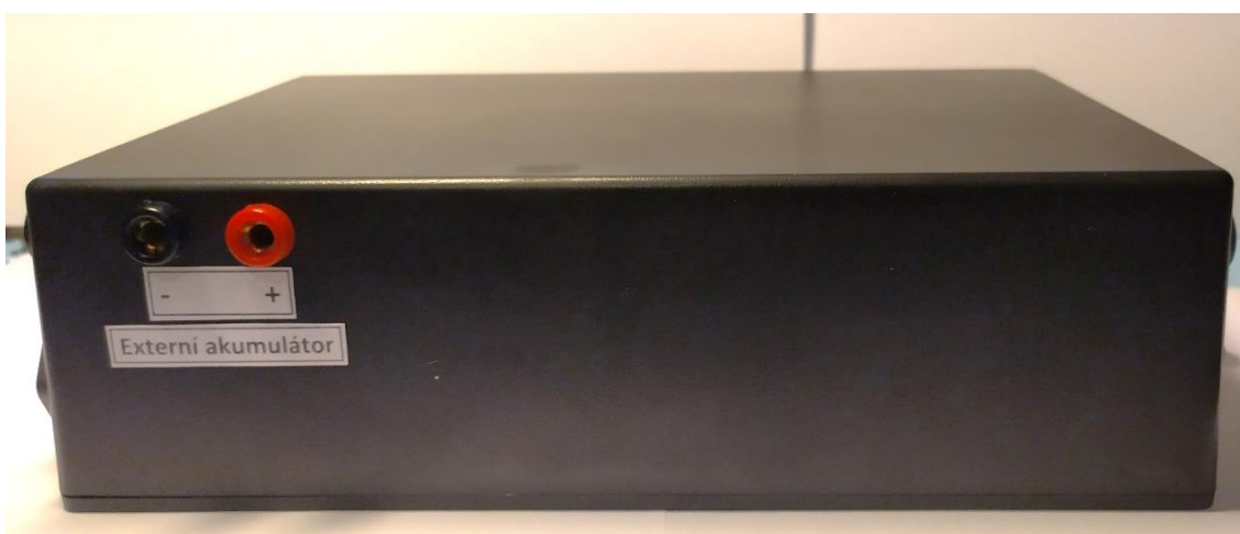
Obr. 2.33: Svorky pro připojení externího akumulátoru
