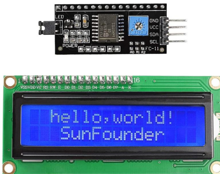
Obr. 2.11: LCD modul 16×2 (převzato z [15])
