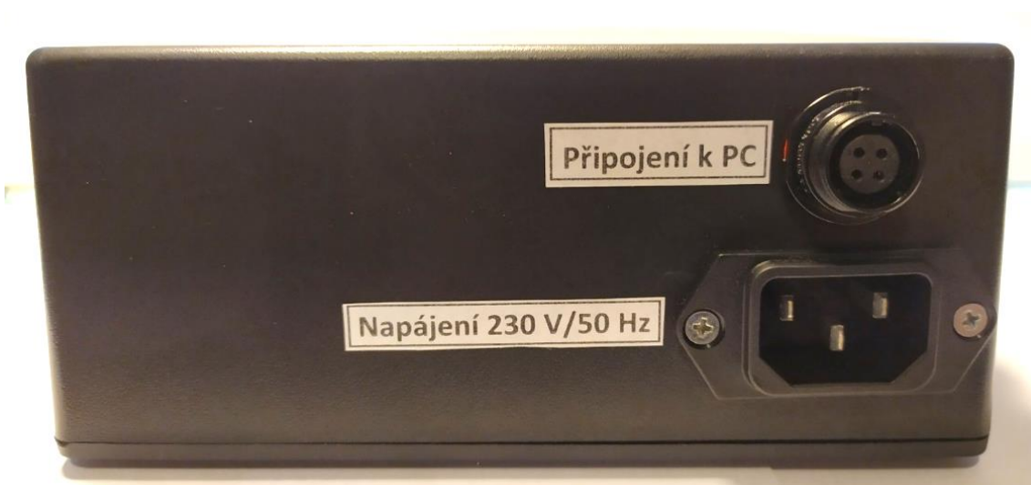
Obr. 2.34: Zadní strana zdroje s konektory pro napájení a připojení k PC
