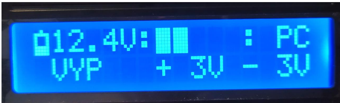
Obr. 2.32: Zobrazené informace na displeji v zapnutém stavu
