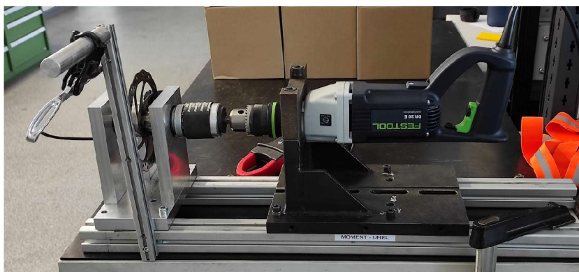
Obrázek 37: Testování měření elektrického proudu
