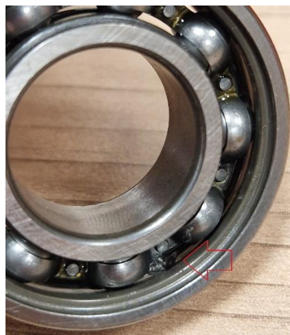
Obrázek 49: Ložisko s vadou l2
