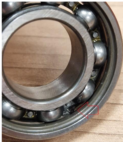
Obrázek 49: Ložisko s vadou l2
