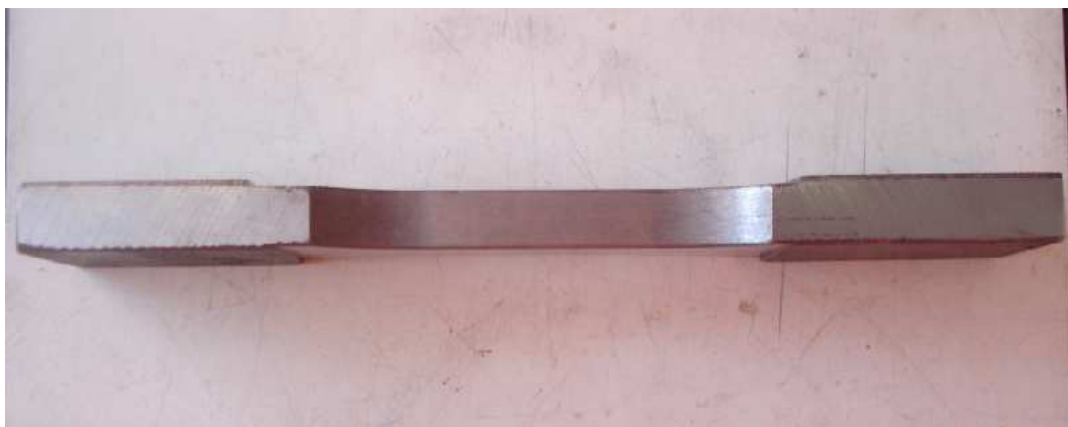
Obr. 32: Zkušební tyč – boční pohled
