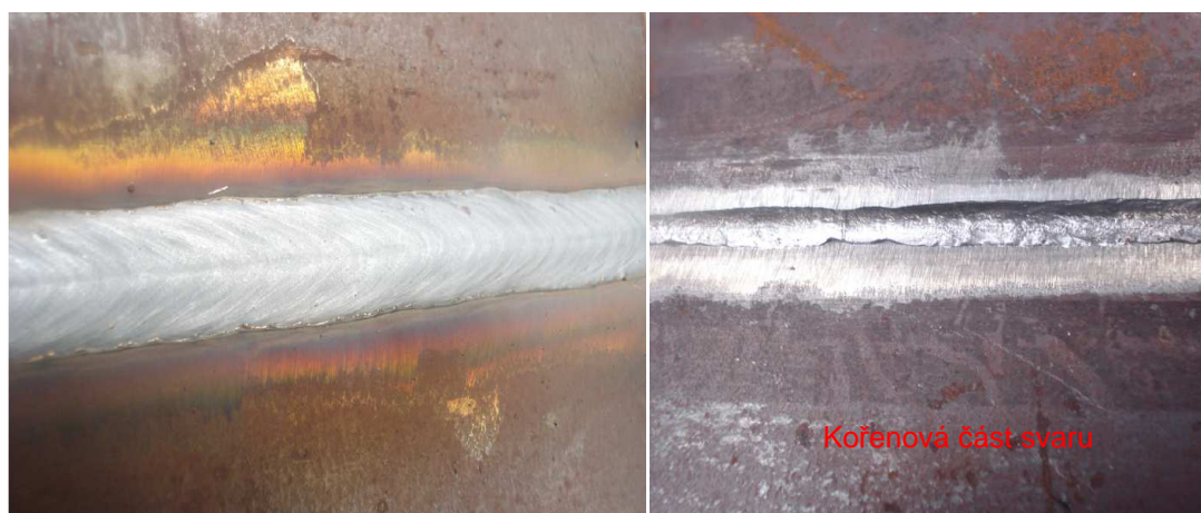
Obr. 28: BW svar provedený metodou ESAB SAT™
