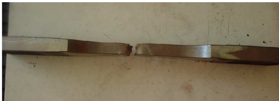
Obr. 34: Oblast přetržení zkušební tyče
