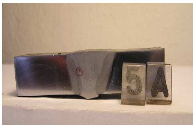
Obr. 46. Zkouška tvrdosti – svar BW
