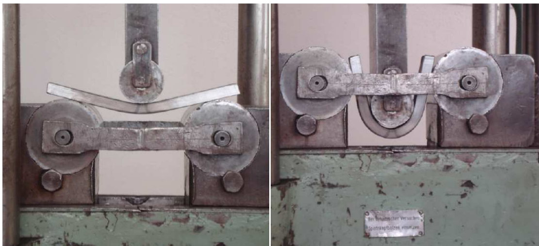
Obr. 36: Ohyb zkušební tyče ze strany kořene
