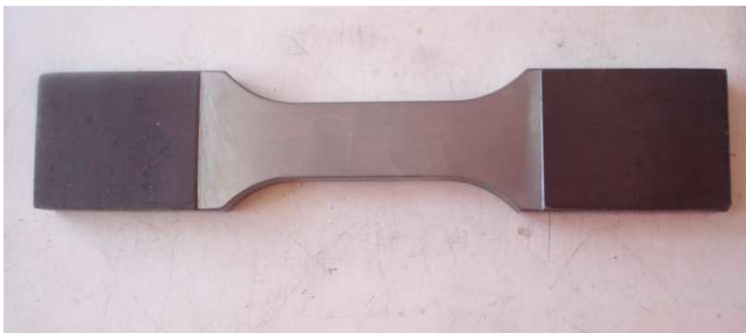
Obr. 31: Zkušební tyč pro zkoušku tahem
