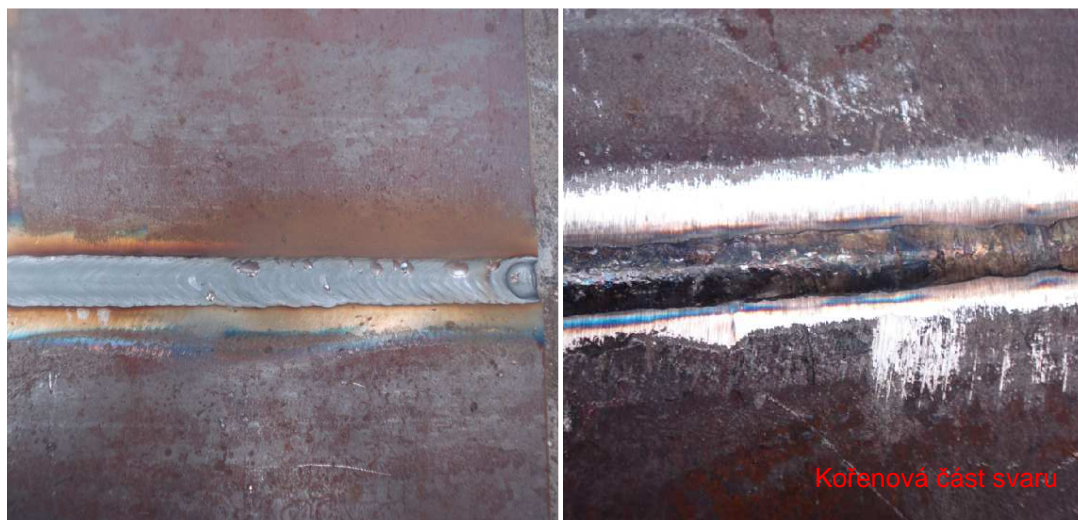
Obr. 27: BW svar provedený metodou – konvenční MAG
