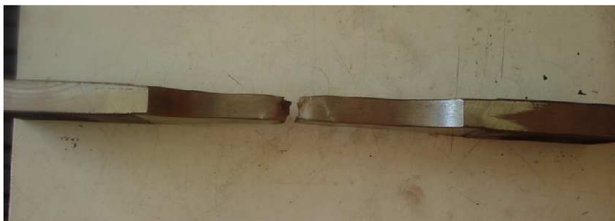
Obr. 34: Oblast přetržení zkušební tyče
