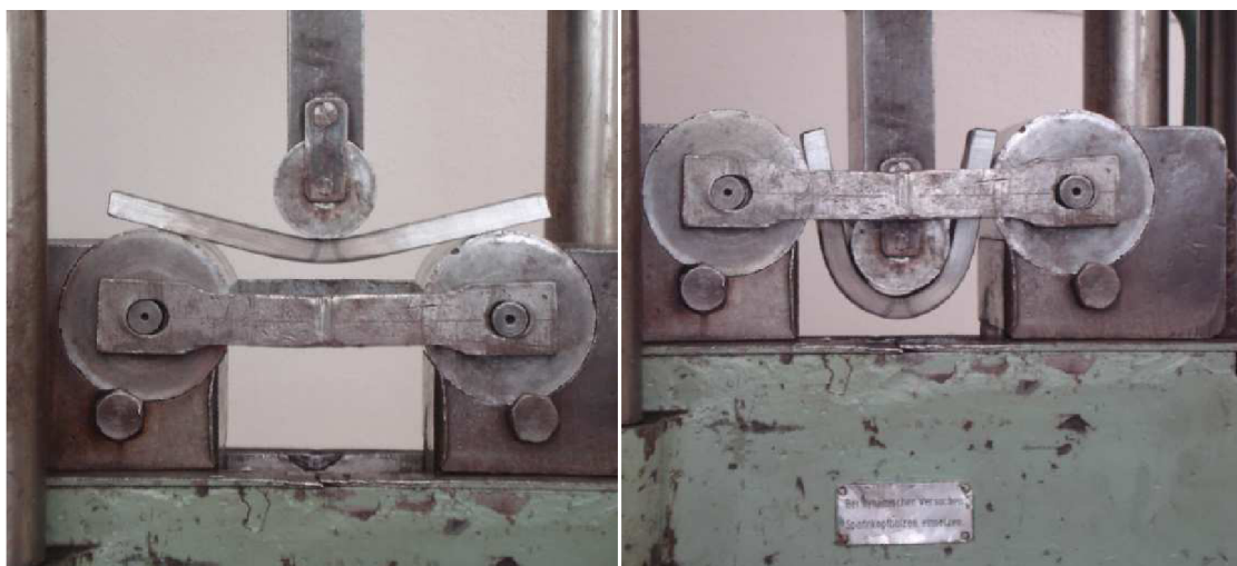
Obr. 36: Ohyb zkušební tyče ze strany kořene
