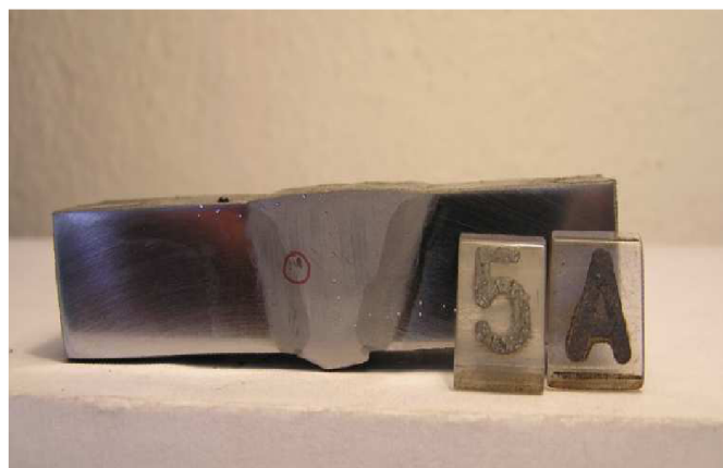
Obr. 46. Zkouška tvrdosti – svar BW
