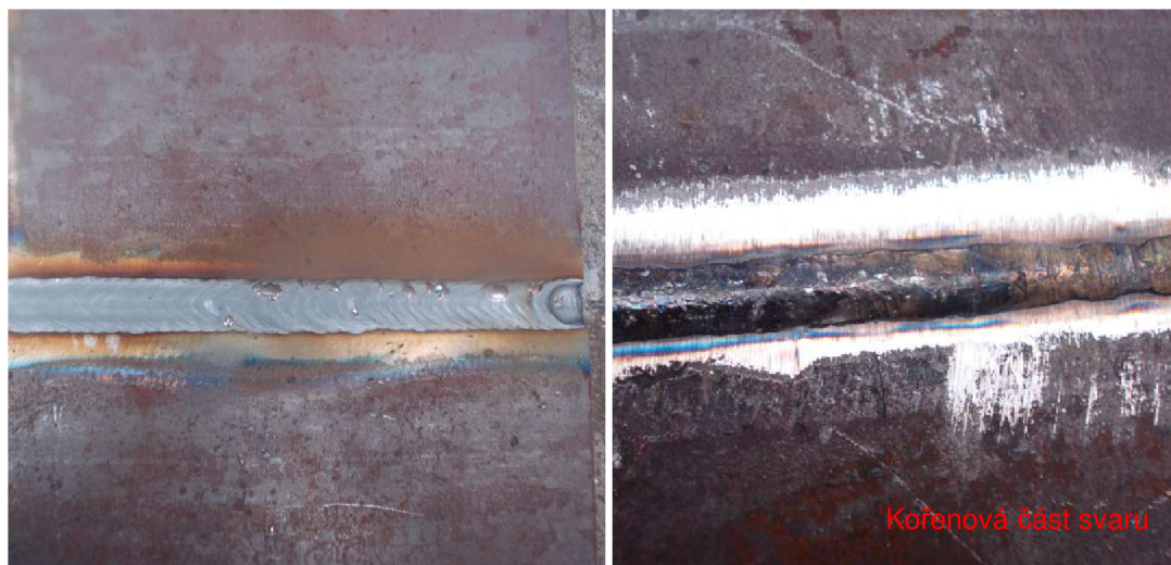
Obr. 27: BW svar provedený metodou – konvenční MAG
