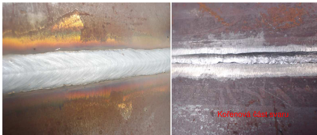
Obr. 28: BW svar provedený metodou ESAB SAT™
