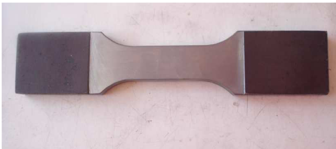
Obr. 31: Zkušební tyč pro zkoušku tahem
