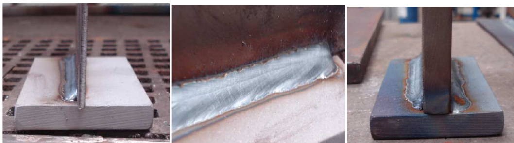
Obr. 29: Ukázky vybraných vzorků s koutovými svary - ESAB SAT TM
