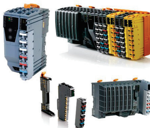
obr. 4 Sestava PLC, žluté moduly představují vstupy openSafety [19]
