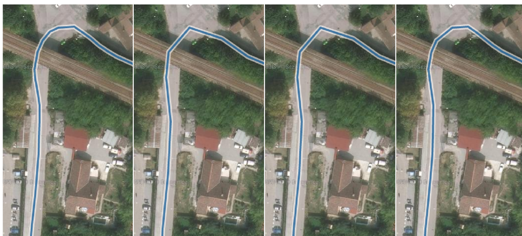
Obrázek 7.2: Srovnání přesnosti vykreslení trasy v závislosti na počtu kreslených bodů. Zleva: originál (všechny body, cca 4000), 500 bodů, 1000 bodů a 2000 bodů trasy.
