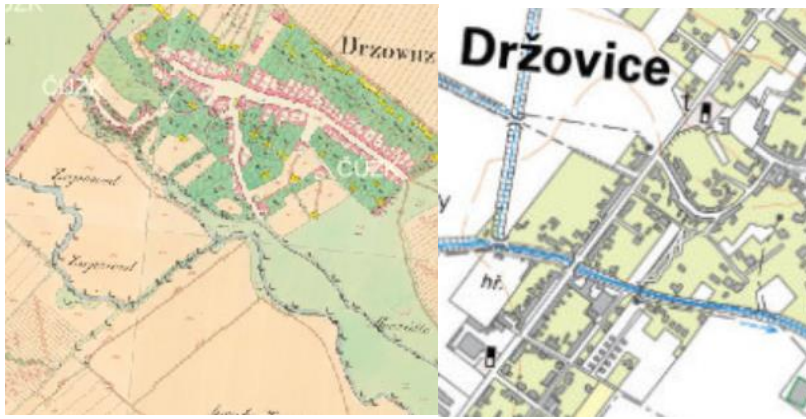
Obr. 40 Zákřuta na řece Romži u obce Držovice na císařském otisku (vlevo) v porovnání se zregulovaným korytem Romže v současnosti na Základní mapě ČR 1:10 000
