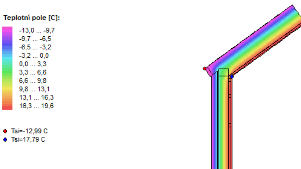
Obrázek 27: Grafický výsledek dvourozměrné simulace – teplotní pole
